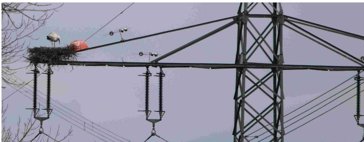
Nest über Stromleitung: Durch Vergrämnungsmaßnahmen im ungefährdeten Bereich des Freileitungsmastes ist der Storch dazu genötigt sein Nest oberhalb der stromführenden Leitung zu errichten, was zu Komplikationen durch herunterfallenden Ästen führen kann.
